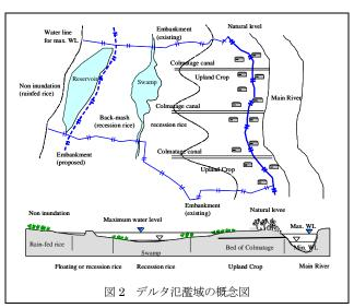
り、居住空間であるとともに、重要な周年畑作地となっている。また、土砂堆積は天然の肥沃度維持に 貢献してきた。現状のコルマタージュ水路においては、乾季の灌漑水源など新たな活用が始まる一方で、 水路壁の崩壊や水路床の土砂堆積などにより、洪水流導入の機能低下が観察される。こうした機能低下 の防止しつつ、多面的活用の方策を探る必要がある。
